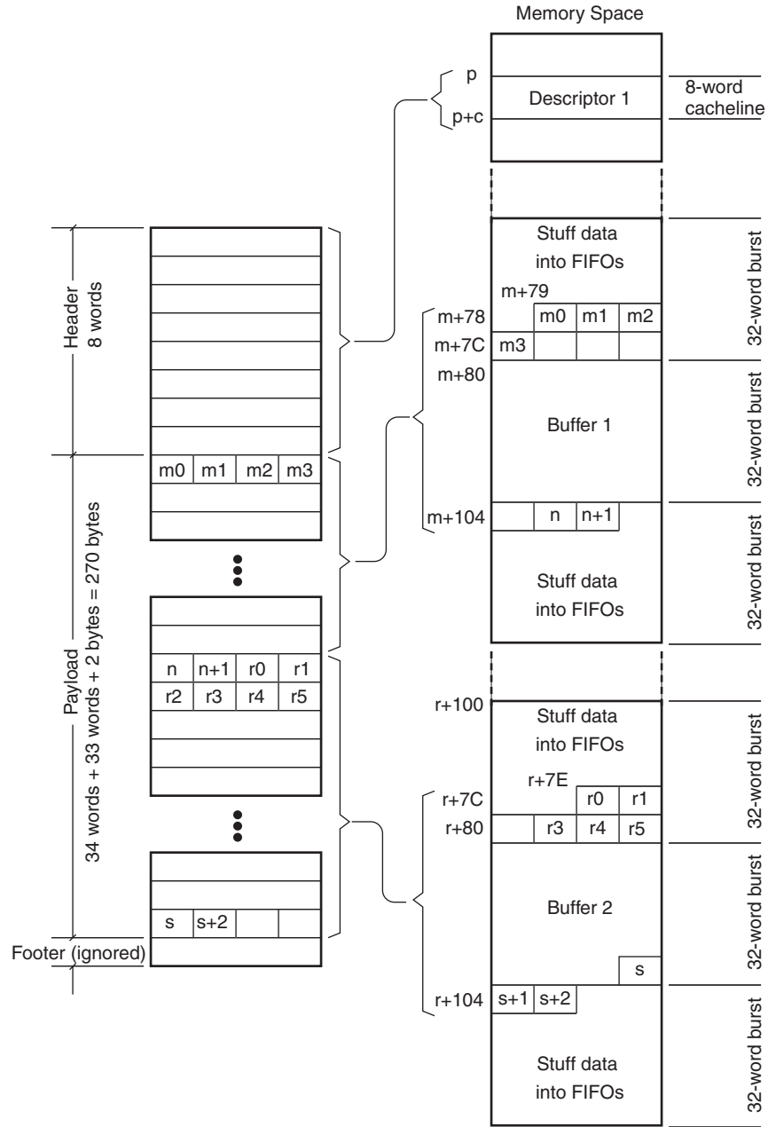
Figure 20: Transmit Byte Shift Example
